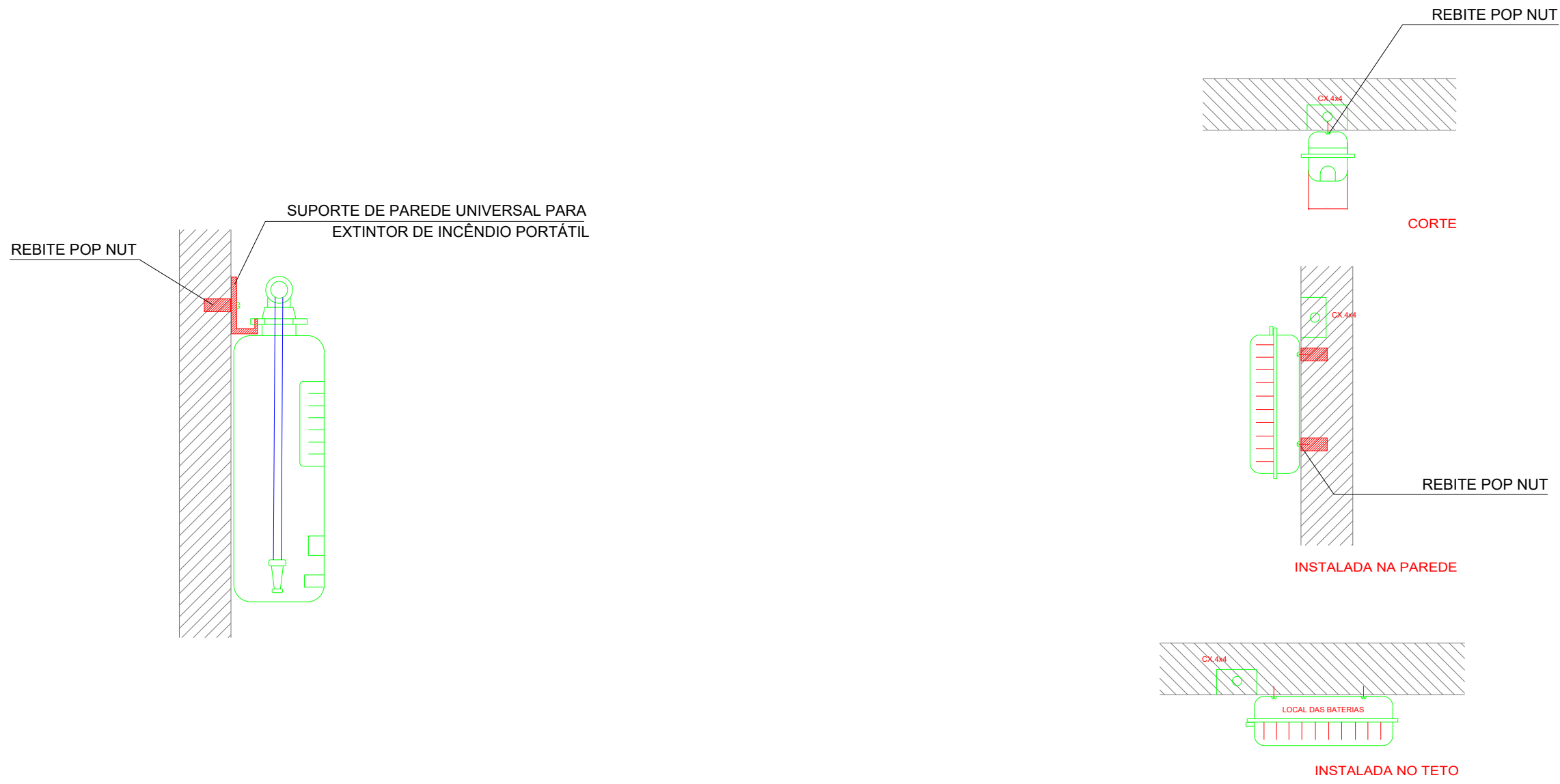
2 DETALHE 1 - FIXAÇÃO DO EXTINTOR SEM ESCALA
